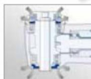
> Système double étanchéité NSK pour empêcher le sang et les liquides oraux de pénétrer dans la tête de l'instrument pour prolonger ainsi la vie de vos instruments.
